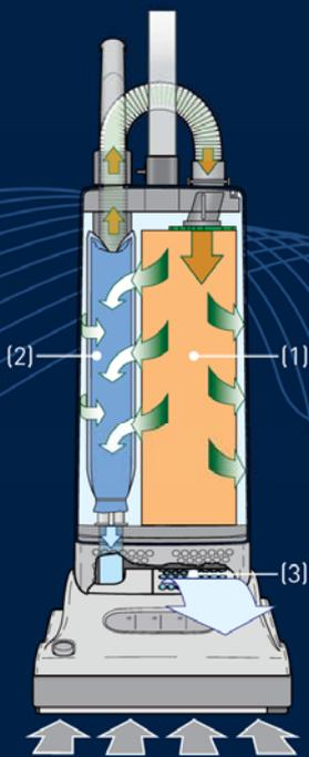
(1) Die verschließbare 3-lagige Filtertüte bildet die erste Stufe des geschlossenen Microfiltersystems und ist 5,3l groß. Sie wird von oben befüllt, damit sich der Schmutz beim Saugen legt und nicht weiter herumwirbelt. So wird das Volumen optimal ausgenutzt und die Filtertüte seltener gewechselt.
